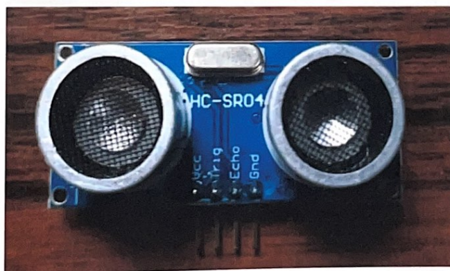
Рисунок 2.5 – Ультразвуковой дальномер HC-SR04
